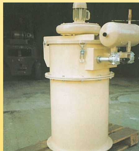
Στρογγυλό φίλτρο με ενσωματωμένο ανεμιστήρα
