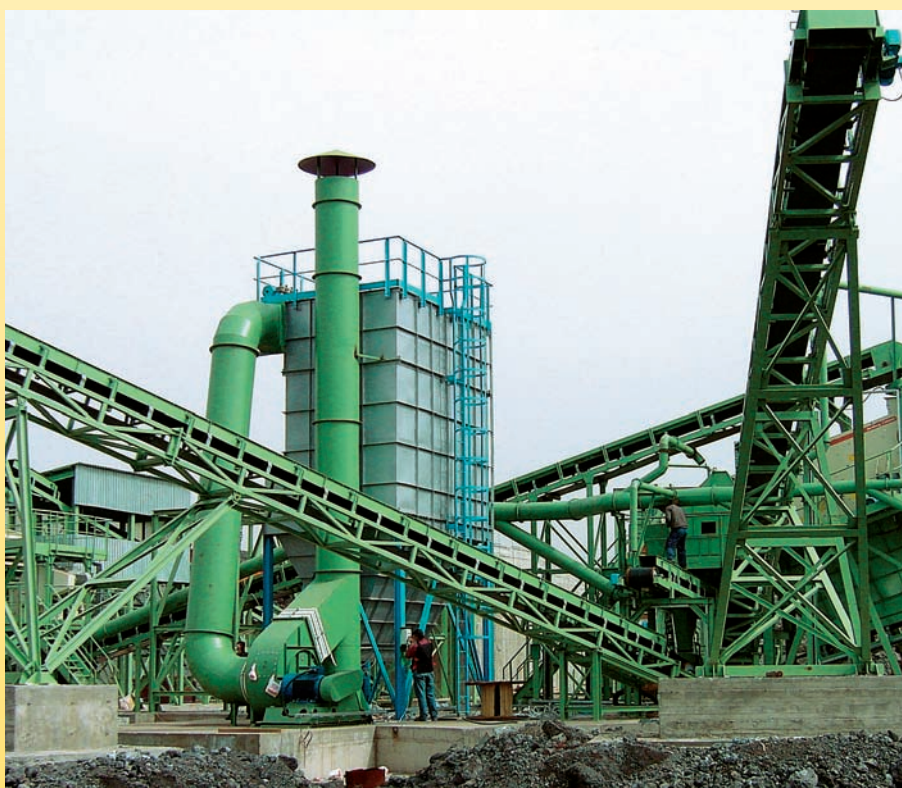
Φίλτρο αποκόνισης εγκατάστασης επεξεργασίας σκωριών χαλυβουργίας 40000 m 3 /h
